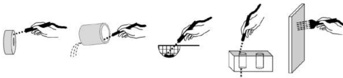
图 3: 不同样品类型的压力冲洗示范[VDA-19.1]
