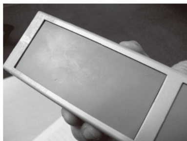
图1 样品5号-a按照TS-BD-002-2009 测试480 h后的曝晒面照片
